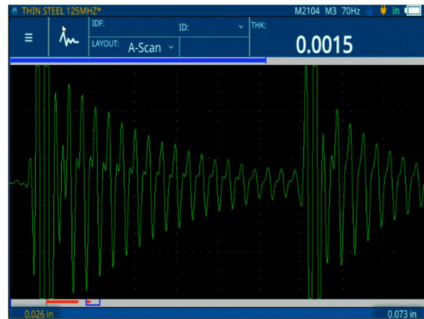
Der 72DL PLUS Dickenmesser bei der Messung von dünnem Stahl (0,0015 Zoll oder 0,0381 mm) mit dem M2104 (125 MHz) Prüfkopf
